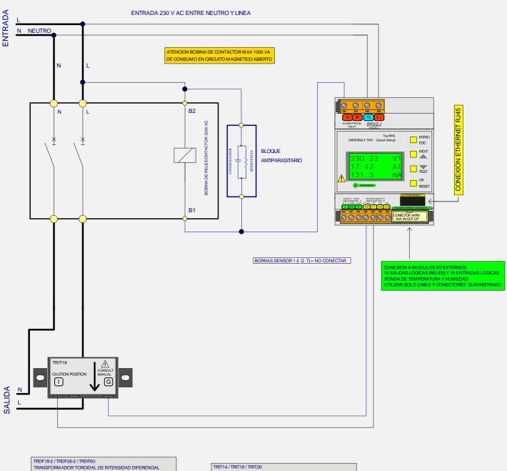
TRANSFORM ADOR TOROIDAL DE INTENSIDAD DIFERENCIAL PASAR LOS CONDUCTORES FASE (L) Y NEUTRO (N) POR EL ORIFICIO DEL TRANSFORMADOR TOROIDAL INDIVIDUALMENTE EM PAREJADO Y AJUSTADO PARA SU MODULO NO INTERCAM BIAR Y POSICIONARLO SEGUN SENTIDO FLECHA TRIT14 / TRIT18 / TRIT26: TRANSFORMADOR TOROIDAL DE INTENSIDAD DE LINEA INDIVIDUALMENTE EMPAREJADO Y AJUSTADO PARA SU MODULO NO INTERCAMBIAR Y POSICIONARLO SEGUN SENTIDO FLECHA
