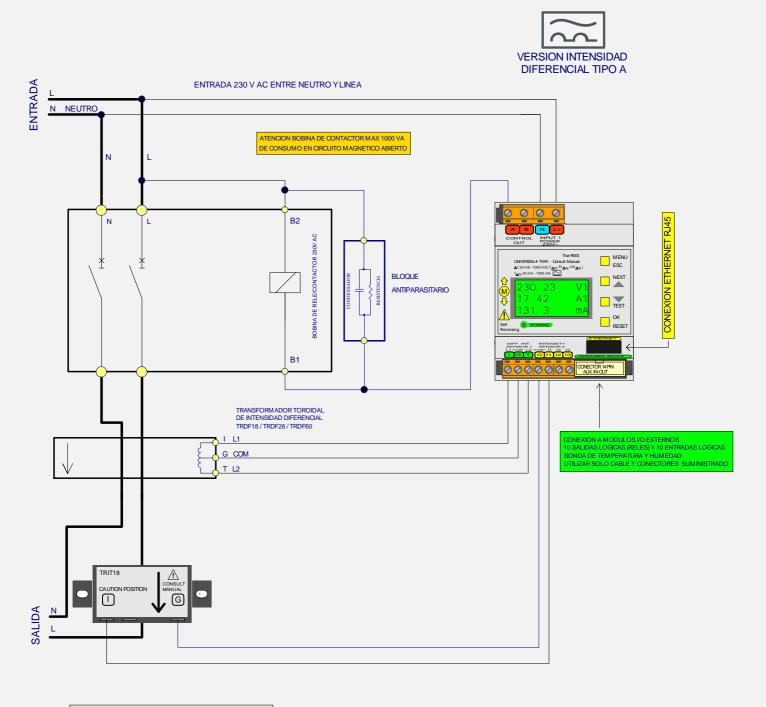
TRDF18 / TRDF26 / TRDF60: TRANSFORMADOR TOROIDAL DE INTENSIDAD DIFERENCIAL PASAR LOS CONDUCTORES FASE (L) Y NEUTRO (N) POR EL ORIGIO DEL TRANSFORMADOR TOROIDAL INDIVIDUALMENTE EMPAREJADO Y AJUSTADO PARA SU MODULO NO INTERCAMBIAR Y POSICIONARLO SEGUN SENTIDO FLECHA
