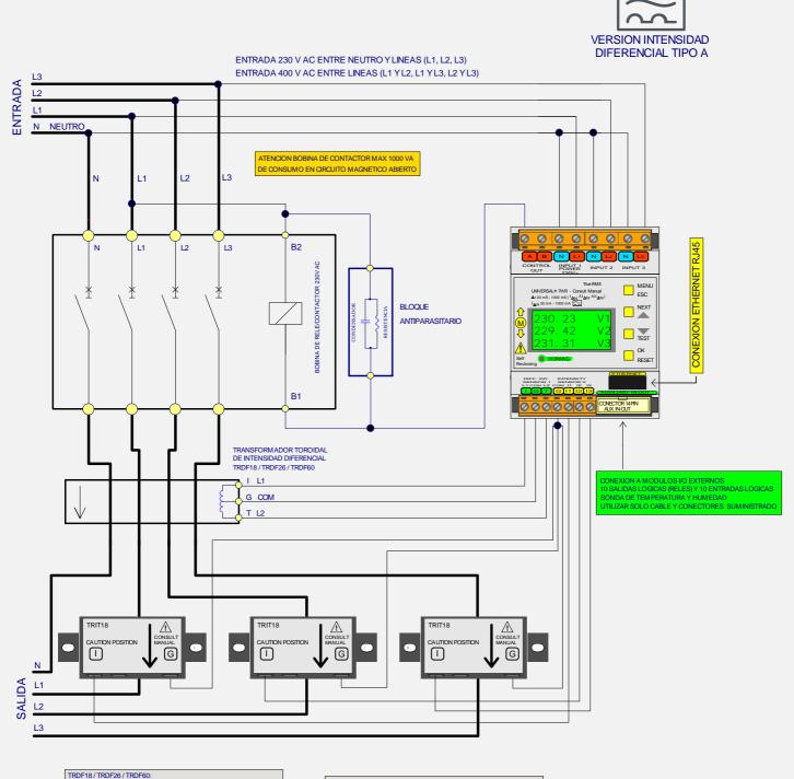
TRD-T8/ TRD-26/ TRD-60: TRANSFORMADOR TOROIDAL DE INTENSIDAD DIFERENCIAL PASAR LOS CONDUCTORES L1, L2, L3 Y NEUTRO POR EL ORIFICIO DEL TRANSFORMADOR TOROIDAL INDIVIDUALMENTE EMPAREJADO Y AJUSTADO PARA SU MODULO NO INTERCAMBIAR Y POSICIONARLO SEGUN SENTIDO FLECHA TRIT14 / TRIT18 / TRIT26: TRANSFORM ADOR TOROIDAL DE INTENSIDAD DE LINEA INDIVIDUALMENTE EMPAREJADO Y AJUSTADO PARA SU MODULO NO INTERCAMBIAR Y POSICIONARLO SEGUN SENTIDO FLECHA
